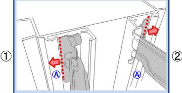
スプリングアングルの斜辺部(図の点線部)を力骨(A) 部に沿って平行にし、斜辺部をA部の中に入れてくだ さい。
