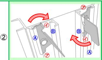
ナットプレートの⑦部を支点に、矢印方向(右回り)に 回転させて、①部を力骨®部にはめてください。
