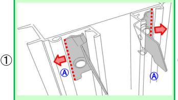
ナットプレートの斜辺部(図の点線部)を力骨(A)部に 沿って平行にし、斜辺部をA部の中に入れてください。
