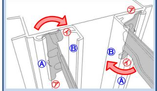
スプリングアングルの⑦部を支点に、矢印方向(右回 り)に回転させて、①部を力骨®部にはめてください。
